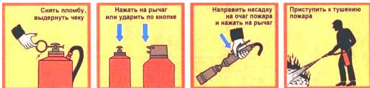
Рисунок 6 - Принцип действия воздушно-пенного огнетушителя типа ОВП
