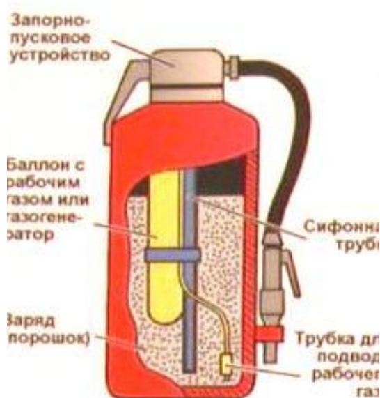
Рисунок 3 - Схема приведения в действие закачного огнетушителя.
