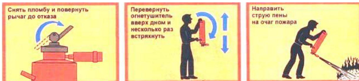
Рисунок 5 - Принцип действия химического пенного огнетушителя типа ОХП
