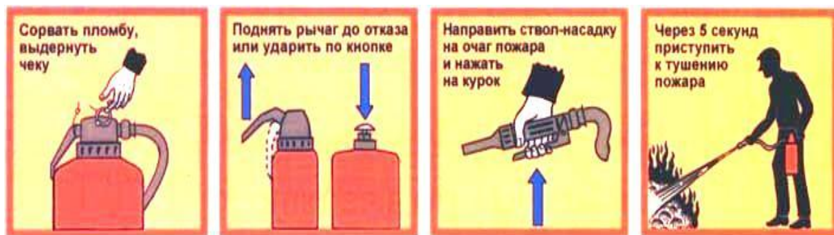
Рисунок 4 - Принцип действия огнетушителя со встроенным источником давления
