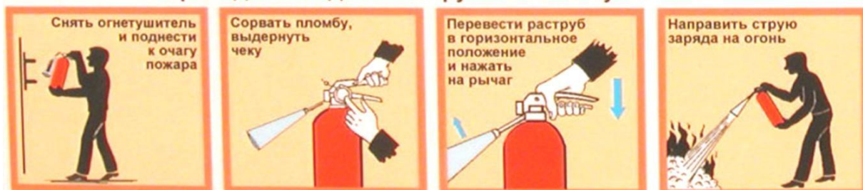
Рисунок 7- Принцип действия углекислотного огнетушителя ручного типа
